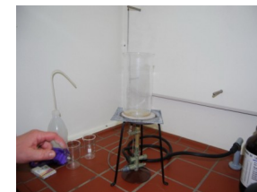
Predpriprava vzorca krompirja z mokro oksidativno-kislinsko mineralizacijo
