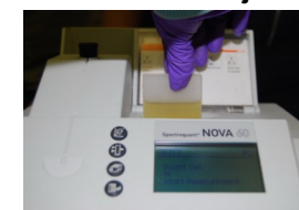
Priprava vzorca krompirja za merjenje s fotometrom
